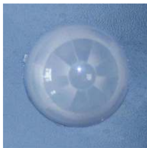
型号:8003-4 焦距:10mm 尺寸: \phi 23.2*18.8 感应角度:120° 感应距离:10m
