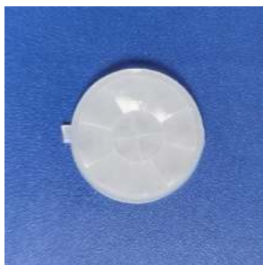
型号:YY-1202 尺寸:Ø22.4 焦距:11mm 感应距离:10m 感应角度:360° 吸顶 6m
