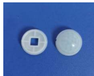
型号:SB-S19焦距:9mm 感应角度: 360^{\circ} 尺寸: \varnothing 18 感应距离: 直径 8m
