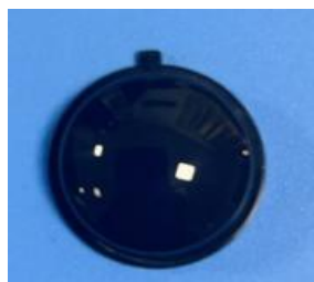
型号:13120F-4 尺寸:Φ 14.2 感应角度:120° 焦距:6mm 感应距离:6m
