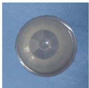
型号:7709-4感应距离:10m 尺寸: \phi 23.7*12.9 焦距:11mm感应角度:120°
