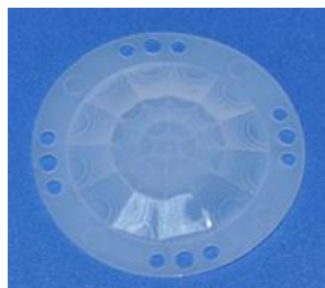
型号:8102-2尺寸:Φ 49*2.6 焦距:15mm 感应角度:360° 吸顶 2.5m 感应距离:直径7m
