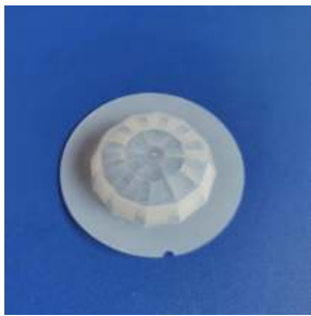
型号:7906-20-G3 尺寸:Ø52.5 焦距:19.6mm 感应角度:360° 感应距离:半径 5.9m
