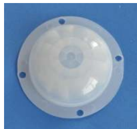
型号:8605-3W 焦距:15mm 尺寸:Φ 43.6*11.4 吸顶 2.5M 感应角度:360° 感应直径:10m
