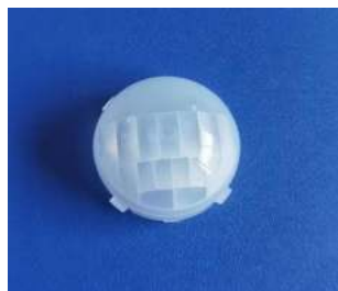
型号:YY-2311 感应距离:10m 尺寸: \phi 23.22*12 可防窥 焦距:11mm 感应角度:120° 无纹区朝下放置 1.2m,
