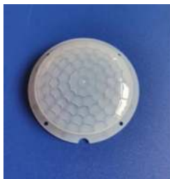
型号:YY-5316-F 尺寸: \varnothing 53*11.6 焦距:20mm感应角度: 360^{\circ} 感应距离: 直径 12m吸顶 6m
