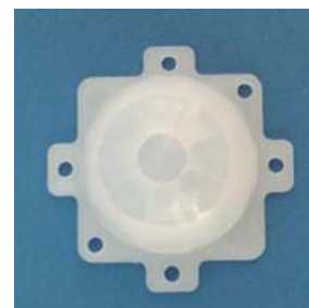
型号:2915 感应角度:360° 尺寸:28.7*21.7*15 焦距:10mm 感应距离:半径8m
