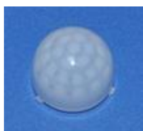
型号:9002-1焦距:12mm 尺寸: \phi 24*19.2 感应角度:360° 感应距离: \phi 10m
