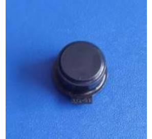
型号:LQ-01 感应角度:90° 焦距:4mm 感应距离:2-3m 尺寸:Φ15.57*8.45
