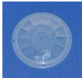
型号:8102-4感应角度:360° 尺寸:Φ 43.1*4.5 焦距:15mm 吸顶 3M/5M 感应直径:8m/14m
