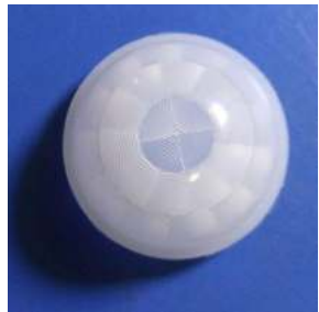
型号:X-23115-1焦距:10.5mm 尺寸: \phi 25.5 感应角度:360° 感应距离:直径10m
