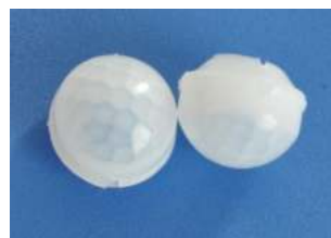
型号:018090壁挂/吸顶 3m 尺寸:Φ17.8*13.94 焦距:9mm感应角度:360° 感应距离:8m/半径 6m
