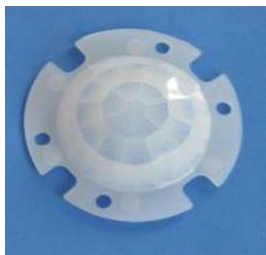
型号:8603-3尺寸:Φ 45.9*11.4 焦距:17.5mm 感应角度:360° 感应距离:直径 10m
