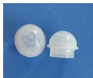
型号:13120F 感应角度:120° 焦距:6mm 感应距离:5-6m 尺寸:Φ 14*10.4
