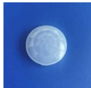
型号:LTX-01 焦距:12.7mm 尺寸: \phi 33.05*9.75 感应角度:120° 感应距离:5m
