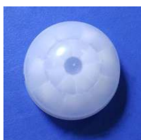
型号:018090-LW焦距:9mm 尺寸: \phi 18.08*13.94 感应角度:140°感应距离:半径8m
