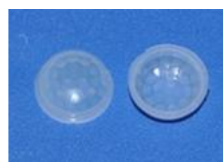
型号:N0803-32 尺寸:Φ 16*6 感应距离:5m 焦距:6mm 感应角度:120°
