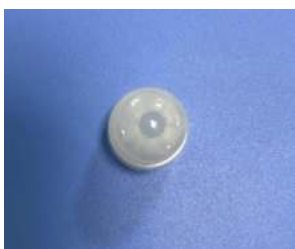
型号:8121-4焦距:5.2mm 尺寸: \varnothing 9.8感应角度: 360^{\circ} 感应距离: 半径 4.5m
