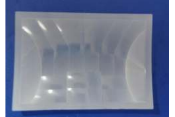
型号:YY-LR-V2 焦距:30.5mm 尺寸:42.6*61 感应距离:28m 感应角度: 154°
