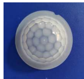
型号:YY-0515 尺寸:Φ 34.3 焦距:19.1mm感应角度:360° 感应距离:直径 12m
