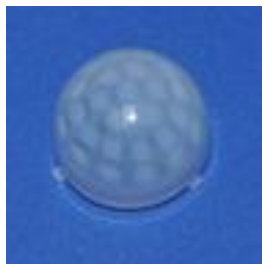
型号:9002-1.7焦距:12mm 尺寸: \phi 24*20 感应角度:360° 感应距离: \phi 10m
