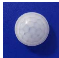
型号 018090-6-M 尺寸:Φ 18mm感应角度:360° 焦距:9mm感应距离:直径 9m
