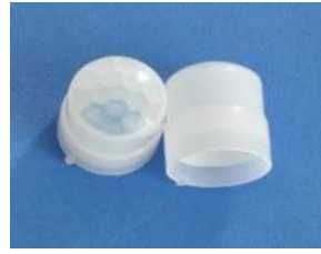
型号:8308-6 焦距:9.6mm 感应角度:90° 感应距离:8m 尺寸:13.6*15.5
