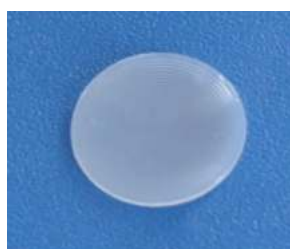
型号:20360 焦距:36mm 尺寸: \phi 20 感应角度: 6^\circ 感应距离: 22m
