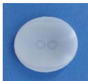
型号:22203 焦距:20mm 尺寸: \phi 22 感应角度: 45^\circ 感应距离: 15m
