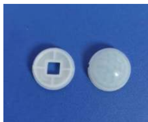
型号:SB-S19 尺寸:Φ18感应角度:120° 焦距:9mm感应距离:8m
