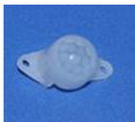
型号:2134-1感应距离:5m 尺寸:26.8*15*17.1 焦距:7.5mm 感应角度:120°
