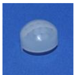
型号:7709-1感应距离:8m 尺寸:Φ20.7*16.9 焦距:7.6mm感应角度:120°
