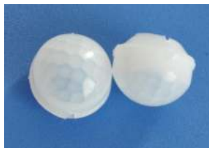
型号:018090感应角度:360° 尺寸:Φ 17.8*13.94 焦距:9mm 壁挂/吸顶3m 感应距离:8m / 半径 6m
