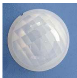
型号:YY-3015 尺寸:Φ34*15感应距离:12m 焦距:15mm感应角度:135°
