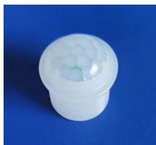
型号:YY-1708-W 尺寸: \phi 17.5 感应角度:110° 焦距:9.5mm 感应距离:9.5m
