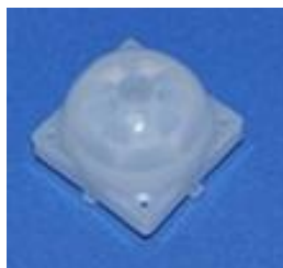
型号:8002-1(孔) 焦距:10.5mm 尺寸:23.5*23.5*19 感应角度:120° 感应距离:10m
