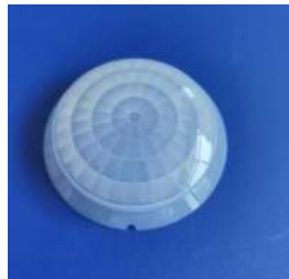
型号:YY-D54-25 焦距:25.4mm 尺寸:Ø63.6 感应角度:360° 感应距离:半径 3.7m
