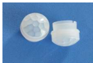
型号:13120F-2感应角度:360° 尺寸:Φ 12.5*10.6 焦距:6mm 感应距离:直径 7m
