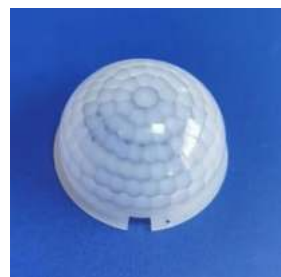
型号:TZ-360 焦距:13.58mm 尺寸: \varnothing 50*25感应角度: 360^{\circ} 感应距离: 半径 10m 吸顶 2.5m, 3 颗 PIR
