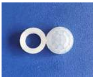
型号:TZ-9812焦距:6.5mm 尺寸: \varnothing 14*11.1感应角度: 360^{\circ} 感应距离: 直径 9m
