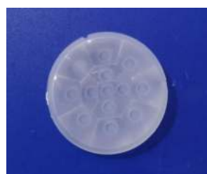
型号:YY-D248 焦距:23mm 尺寸:Φ 38.6 感应角度:53° 感应距离:直径12m 高挂12m
