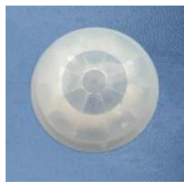
型号:YY-1715焦距:6mm 尺寸: \phi 17 感应角度:360° 感应距离:直径 10m
