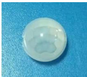
型号:13120F-5 焦距:6mm 感应角度:120° 感应距离:7m 尺寸:Φ 13.7*6.6
