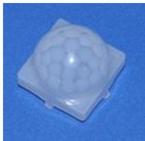
型号: 024120 感应距离: 12m 尺寸: 23.5*23.5*17.2 焦距: 12mm 感应角度: 120°
