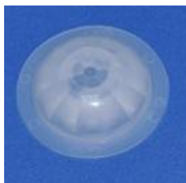
型号:8605-1感应直径:10m 尺寸:Φ 43*12.4 焦距:15mm 感应角度:360°
