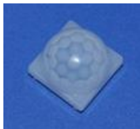
型号: 8002-2 感应距离: 10m 尺寸: 23.3*23.3*14.8 焦距: 10.5mm 感应角度: 360°
