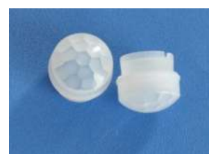
型号:13120F-2 尺寸:Φ 12.5*10.6 焦距:6mm 感应角度:120° 感应距离:6m
