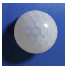
型号:YY-2120焦距:10mm 尺寸: \phi 21 感应角度:360° 感应距离:直径10m
