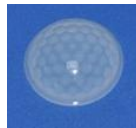
型号:8605-2B 感应距离:Φ 10m 尺寸:Φ 45.7*11.5 焦距:15mm 感应角度:360°
