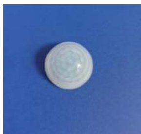
型号:YY-B2010 焦距:10mm 尺寸: \varnothing 23.4*13感应角度: 360^{\circ} 感应距离: 半径 5m
