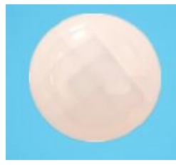
型号: 7709-12 焦距: 10mm 尺寸: 17.8*13.94 感应角度: 120° 感应距离: 10m
